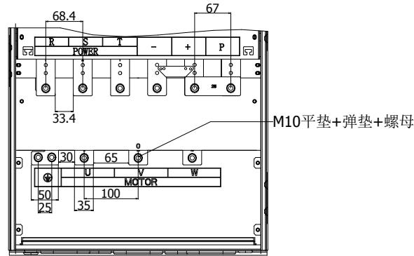
图 4-29: 160~220kW G3 主回路端子 (机座号: F11)
