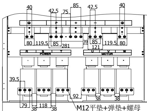
图 4-31：450~630kW G3 主回路端子（机座号：F18）
