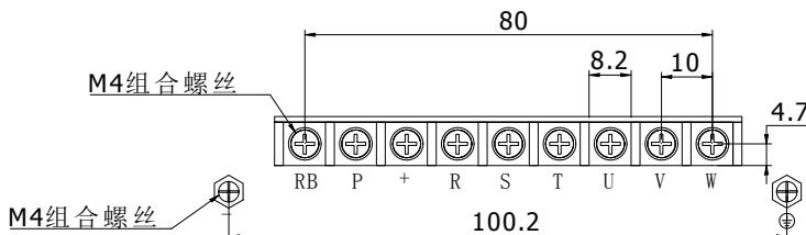
图 4-20: 5.5~11kW G3 主回路端子图 (机座号: F3)
