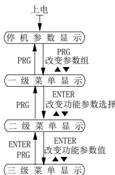
图 5-2: 操作流程图
