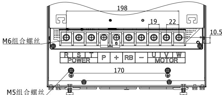
图 4-24: 37~45kW G3B 和 045G3 主回路端子 (机座号: F7)
