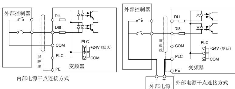
图 4-40：信号输入端子接线图—干接点方式
