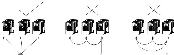
图 4-1：PI500 系列变频器多台并联接地图
