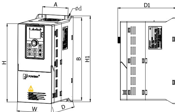
图 4-9： 5.5~11kW G3 外形尺寸（机座号：F3）
