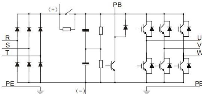
图 3-1 PI500G3B 系列&22kW 及以下主回路简图
