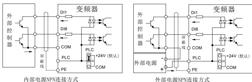
图 4-41：信号输入端子接线图—开路集电极 NPN 接线方式
