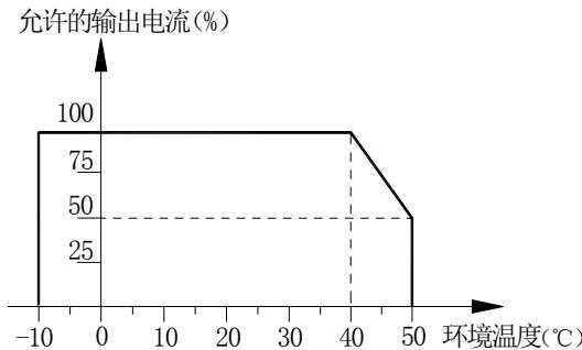
图 2-1：PI500 系列变频器超温降额曲线图
