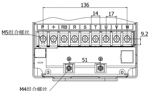
图 4-21: 15~22kW G3 主回路端子图 (机座号: F4)
