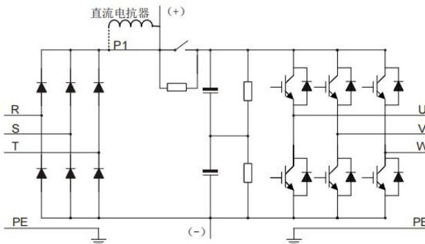
图 3-2 PI500G3 30kW 以上主回路简图
