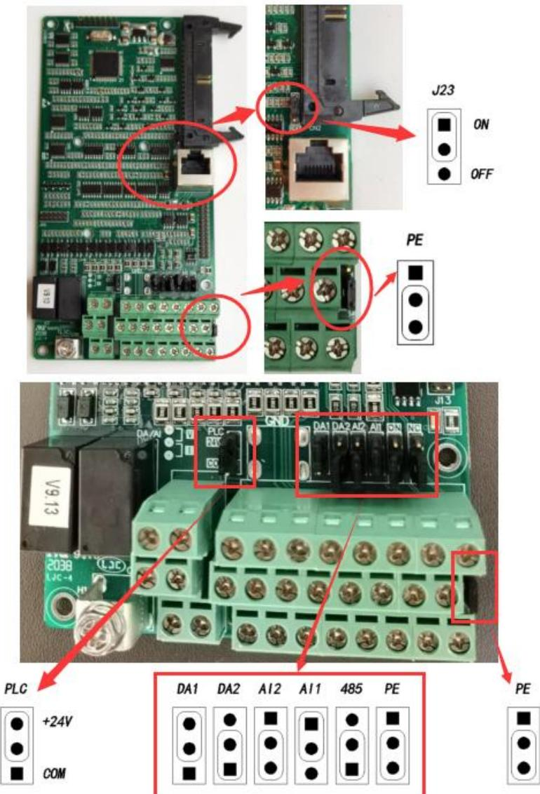
图 4-37： 跳线在 KZ1, KZ2 控制板上的位置
