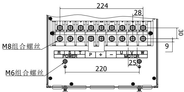
图 4-26: 55~75kW G3 主回路端子图 (机座号: F8)
