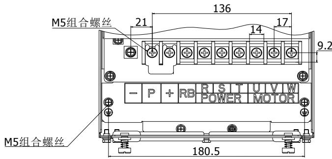
图 4-22: 30kW G3/F3 主回路端子图 (机座号: F5)
