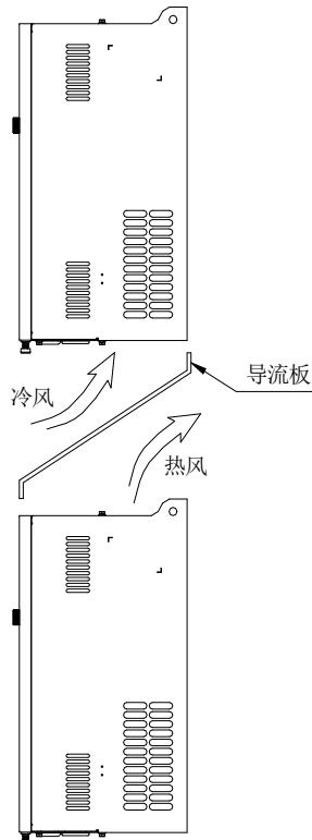
图 4-7: 隔热带流板安装示意图上下安装图
