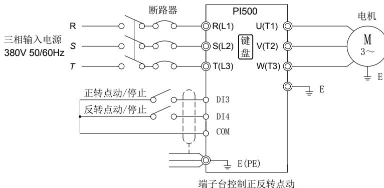
端子台控制正反转点动
