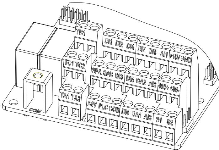
图 4-34：KZ1、KZ2 控制板控制回路端子
