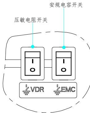
图 4-33：压敏电阻开关（VDR）和安规电容开关（EMC）示意图
