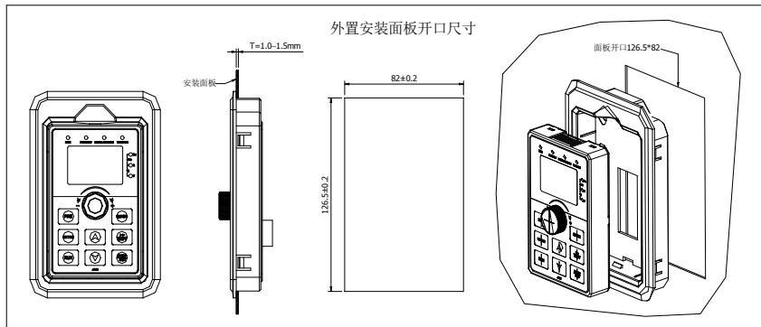
图 4-18：键盘安装开口尺寸图(尺寸单位：mm)
