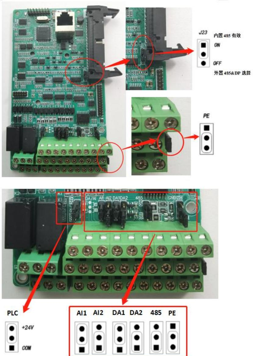
图 4-39： 跳线在 KZ12 控制板上的位置
