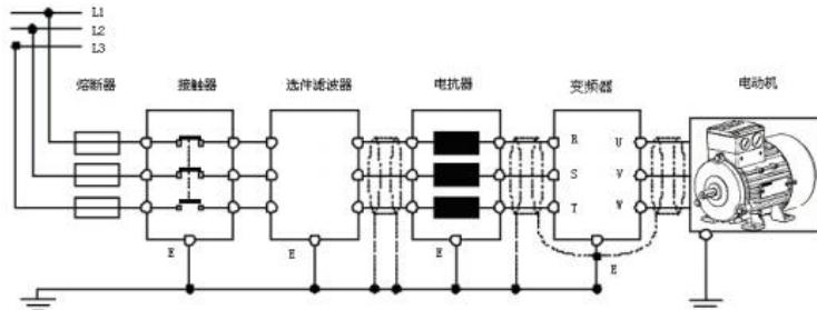
图 4-2：PI500 系列变频器系统接地图
