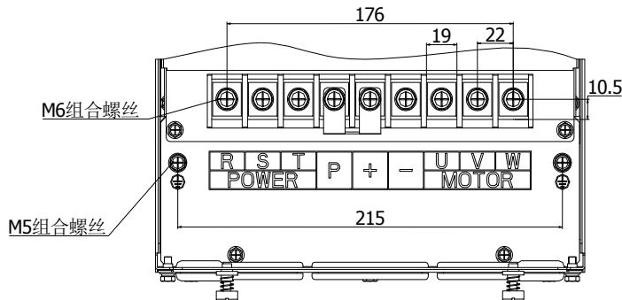
图 4-23: 37kW G3/F3 主回路端子图 (机座号: F6)
