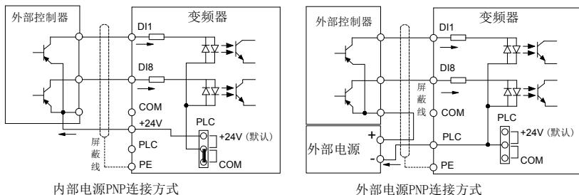
图 4-42: 信号输入端子接线图—开路集电极 PNP 接线方式
