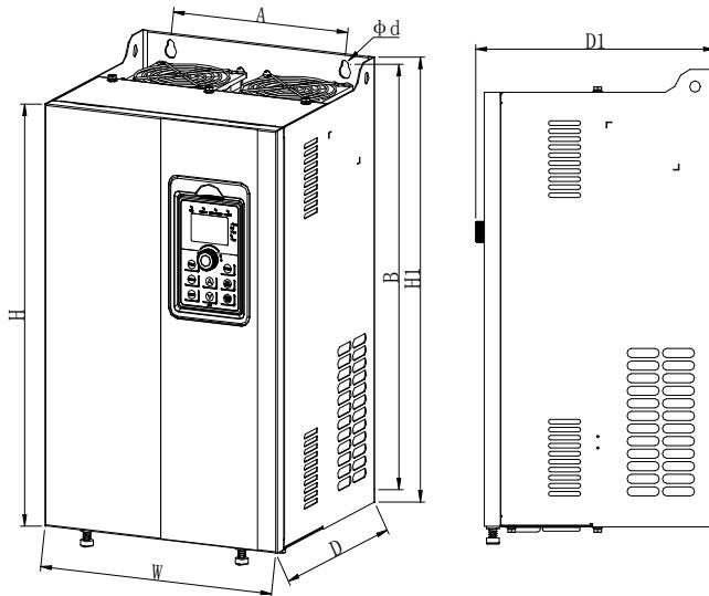
图 4-11: 30~220kW G3 外形尺寸 (机座号: F5~F11)
