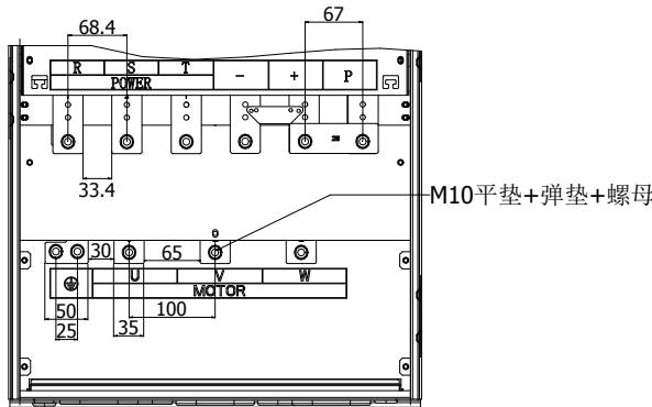
图 4-28: 160kW F3 主回路端子 (机座号: F10)
