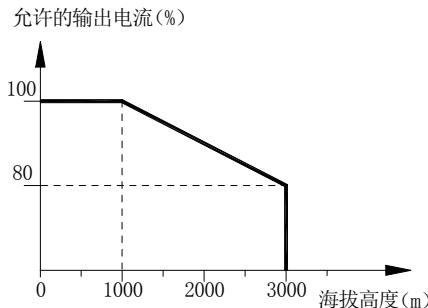
图 2-2: PI500 系列变频器超海拔降额曲线图
