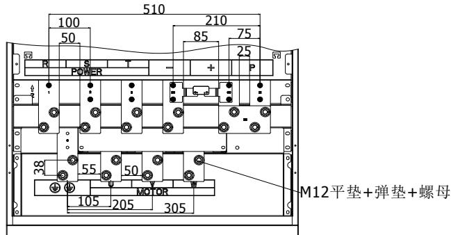
图 4-30: 250~400kW G3 主回路端子 (机座号: F12~F13)
