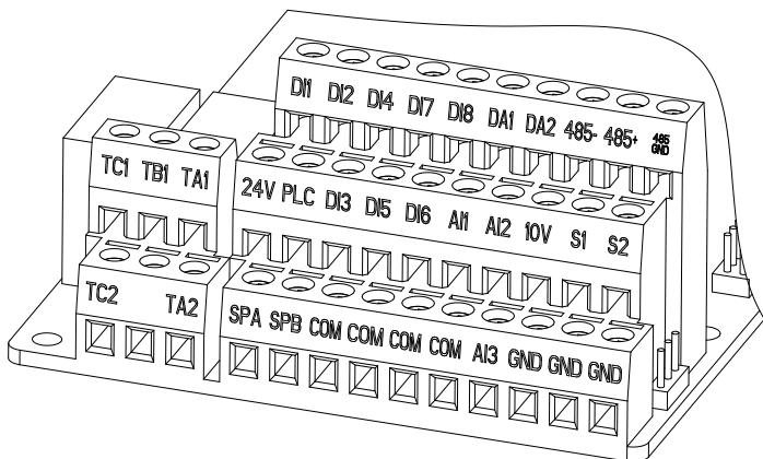
图 4-35：KZ12 控制板控制回路端子
