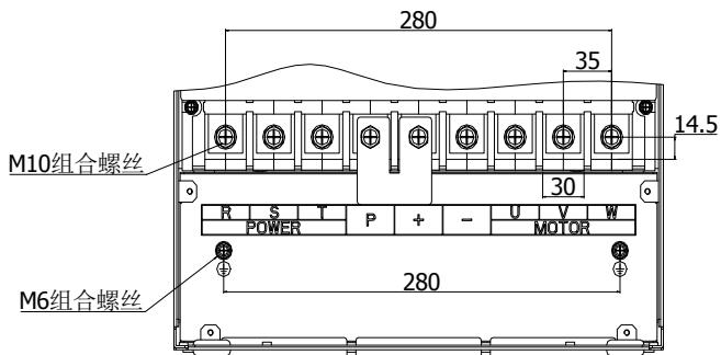
图 4-27: 93~132kW G3 主回路端子图 (机座号: F9)
