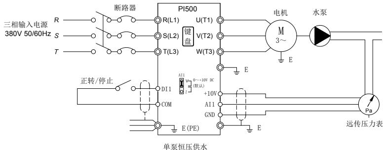
**注：检查接线无误后，合上断路器，变频器上电，按下正转按钮 1-2 秒钟然后停止，检查水泵的运转方向，若方向反了，则改变电机接线相序。**
