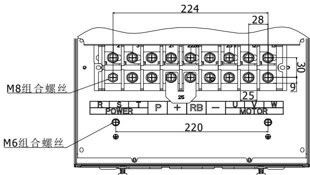
图 4-25: 55~75kW G3B 主回路端子 (机座号: F19)
