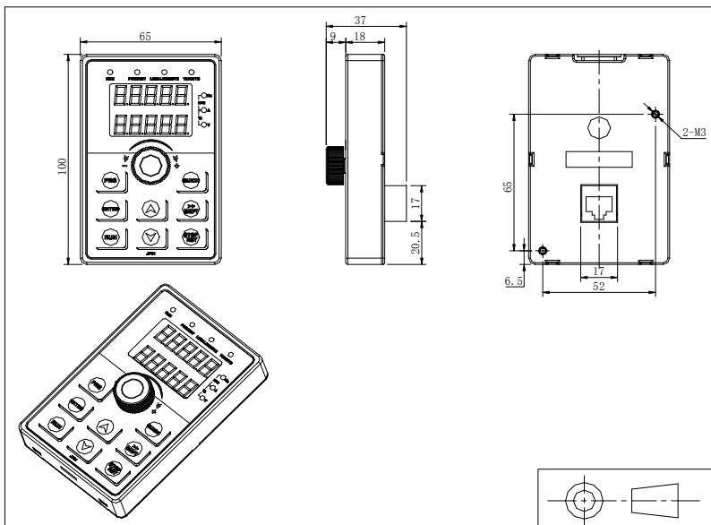
图 4-16：PI500 键盘尺寸图(尺寸单位：mm)
