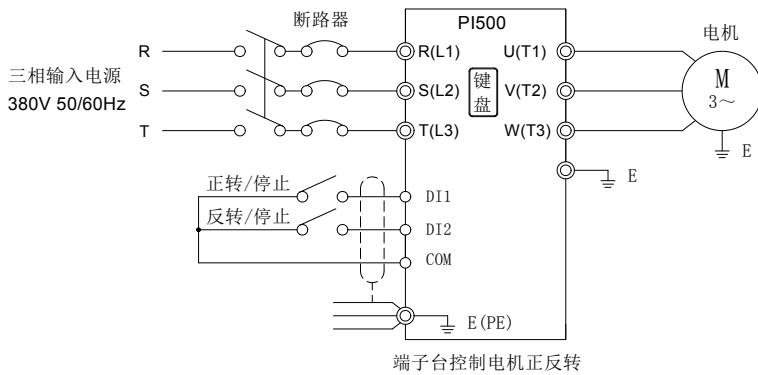
接法：控制端子 DI1 对应正转命令，控制端子 DI2 对应反转命令。
