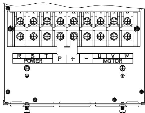
图 4-28: 45~75kW G3 主回路端子图 (机座号: F8)
