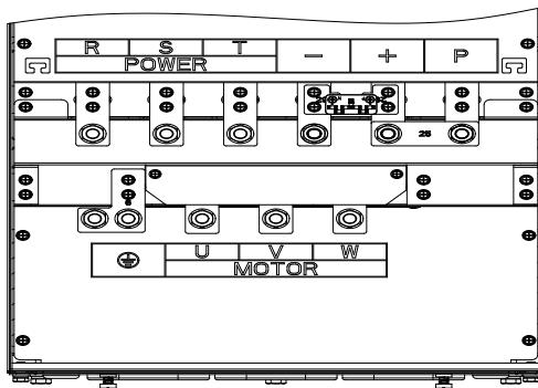
图 4-30: 132kW G3 主回路端子 (机座号: F10)
