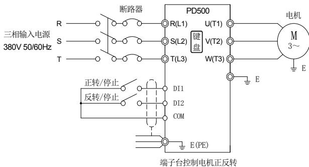
接法：控制端子 DI1 对应正转命令，控制端子 DI2 对应反转命令。
