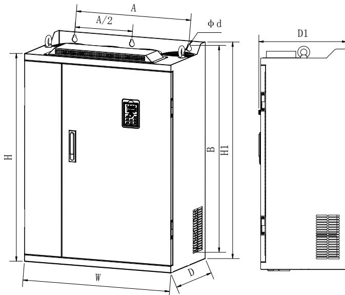
图 4-12: 250~400kW G3 外形尺寸 (机座号: F12~F13)
