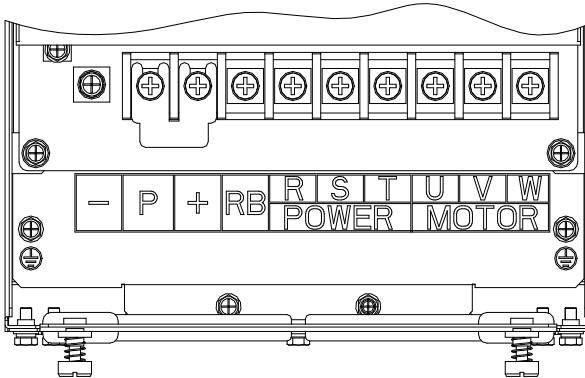
图 4-24: 30kW G3/F3 主回路端子图 (机座号: F5)
