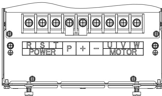
图 4-25: 30~37kW G3 主回路端子图 (机座号: F6)
