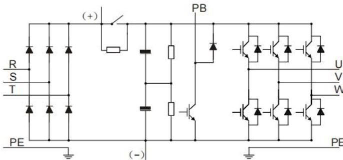
图 3-1 PD500G3B 系列&22kW 及以下主回路简图
