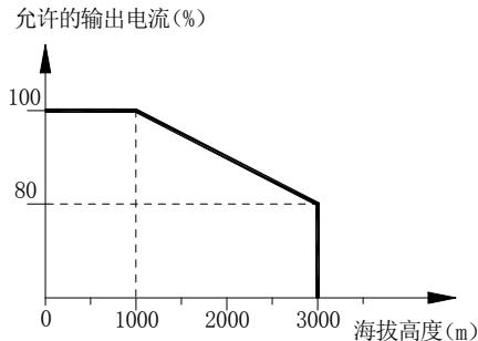
图 2-2: PD500 系列变频器超海拔降额曲线图
