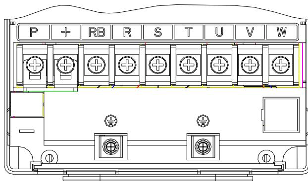
图 4-23: 15~22kW G3 主回路端子图 (机座号: F4)
