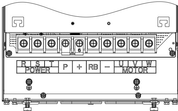
图 4-26: 37~45kW G3B 和 045G3 主回路端子 (机座号: F7)
