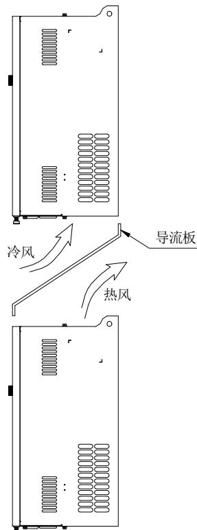
图 4-7: 隔热带导流板安装示意图上下安装图
