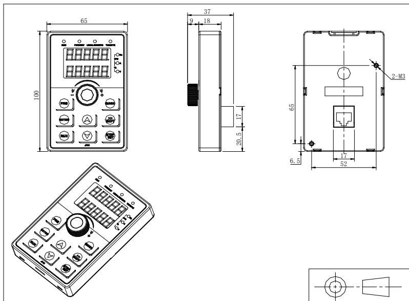
图 4-16: PD500 键盘尺寸图(尺寸单位: mm)
