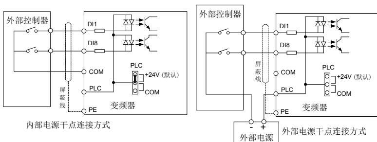
图 4-37: 信号输入端子接线图—干接点方式
