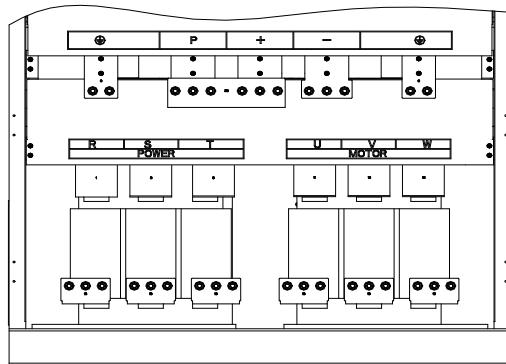
图 4-33: 450~630kW G3 主回路端子 (机座号: F18)
