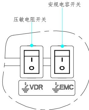
图 4-35：压敏电阻开关（VDR）和安规电容开关（EMC）示意图
