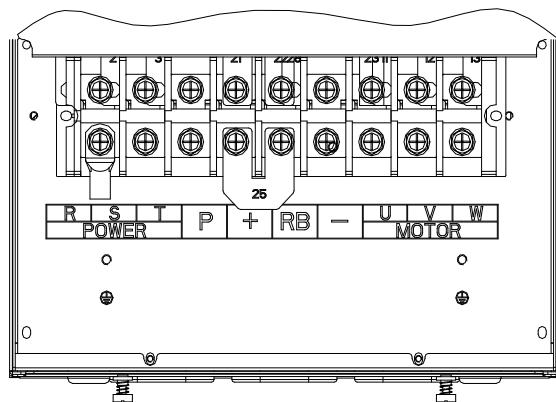
图 4-27: 55~75kW G3B 主回路端子 (机座号: F19)
