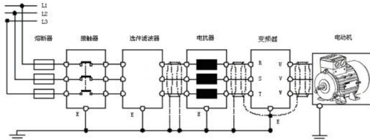
图 4-2：PD500 系列变频器系统接地图
