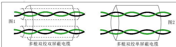
对于低压数字信号来说，最好选择双层屏蔽的电缆，但是也可以采用单层屏蔽的或者无屏蔽的绞线对，如图 2，然而，对于频率信号来说，只能采用屏蔽电缆。
