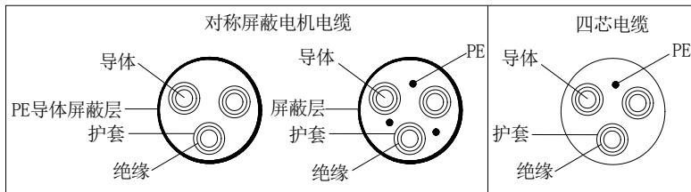
**注意：如果电机电缆屏蔽层的导电性能不能满足要求，必须使用单独的 PE 导体。**
