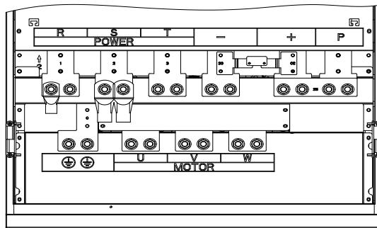
图 4-32: 250~400kW G3 主回路端子 (机座号: F12~F13)
