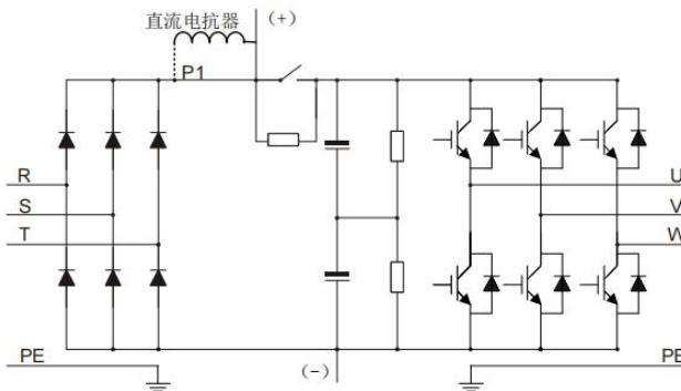
图 3-2 PD500G3 30kW 以上主回路简图
