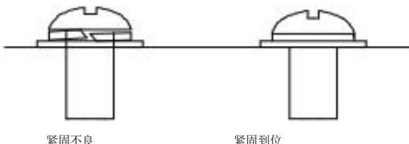
图 4-34：螺丝紧固图示
