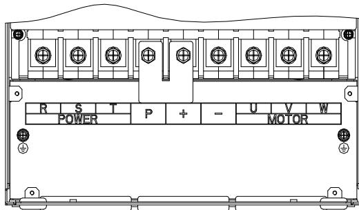
图 4-29: 93~110kW G3 主回路端子图 (机座号: F9)
