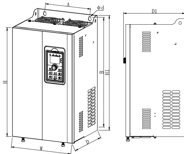
图 4-11: 30~220kW G3 外形尺寸 (机座号: F5~F11)
