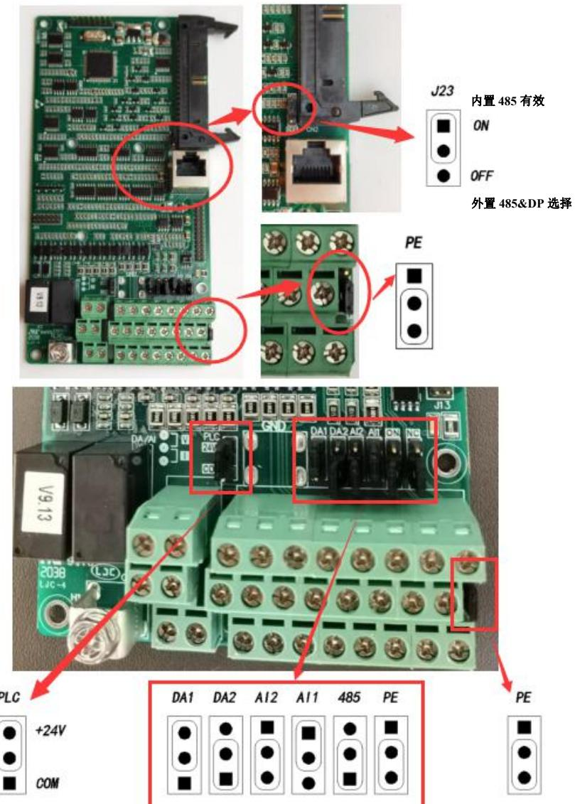
图 4-20: 跳线在控制板的位置
