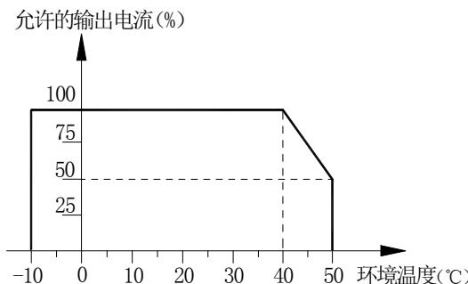
图 2-1：PD500 系列变频器超温降额曲线图
