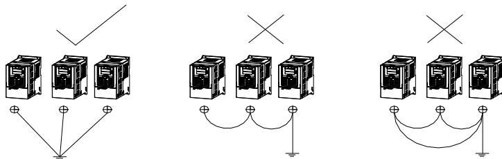
图 4-1：PD500 系列变频器多台并联接地图
