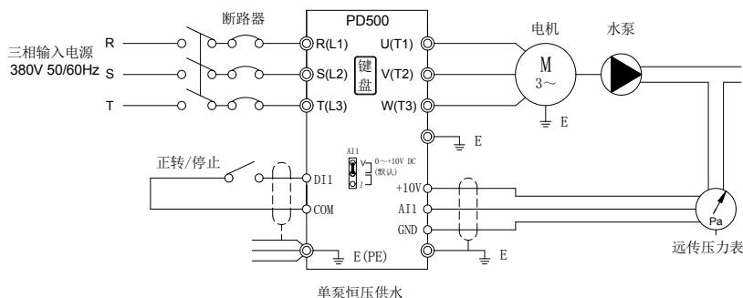
**注：检查接线无误后，合上断路器，变频器上电，按下正转按钮 1-2 秒钟然后停止，检查水泵的运转方向，若方向反了，则改变电机接线相序。**
