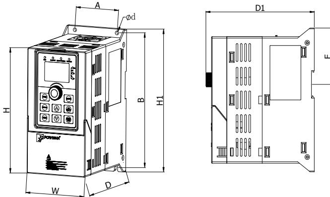
注：机座号：F1~F2 支持导轨安装
