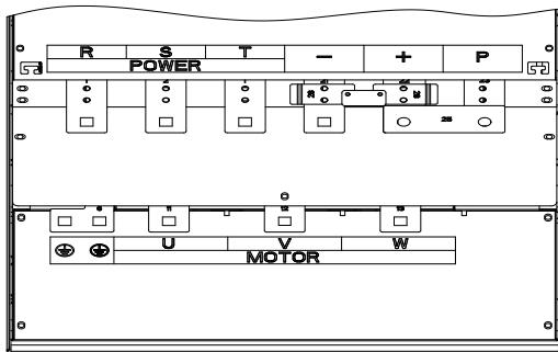
图 4-31: 160~220kW G3 主回路端子 (机座号: F11)
