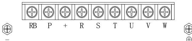
图 4-22: 5.5~11kW G3 主回路端子图 (机座号: F3)
