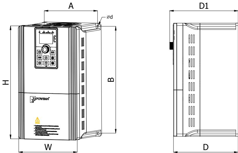
图 4-10: 15~22kW G3 外形尺寸 (机座号: F4)
