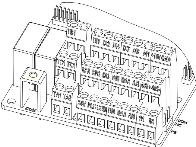
图 4-36：控制板控制回路端子
